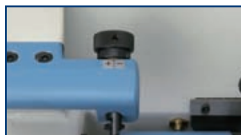
2 Taster mit Mikrometereinstellung.
