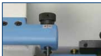
2 Pilot z regulacją mikrometryczną
